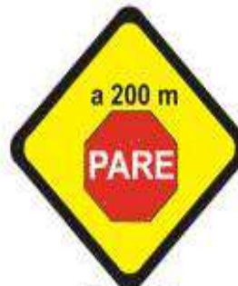
P 33(a) PROXIMIDAD DE SEÑAL RESTRICATIVA(pare)
