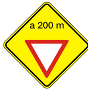
Proximidad de Señal Restrictiva (Paso) P 33
