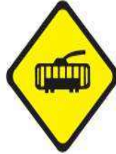
P 29(a) PRESENCIA DE VEHÍCULOS EXTRAÑOS (tranvía)
