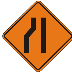
Estrechamiento de Calzada T 4
