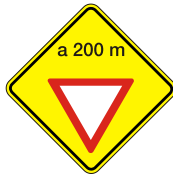
Proximidad de Señal Restrictiva (Paso) P 33
