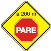
Proximidad de Señal Restrictiva (Pare) P 33
