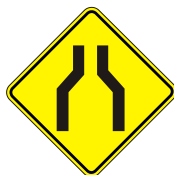
Estrechamiento (En las dos manos) P10
