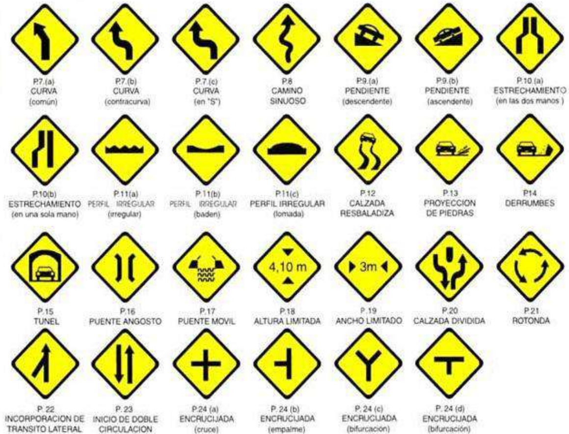
Señales Preventivas - Advertencia Sobre características Físicas de la vía
