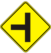
Encrucijada (Empalme) P 24
