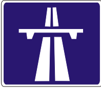
Comienzo de Autopista I 12
