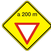
Proximidad de Señal Restrictiva (Paso) P 33
