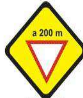
P 33(b) PROXIMIDAD DE SEÑAL RESTRICTIVA(paso)
