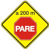
Proximidad de Señal Restrictiva (Pare) P 33
