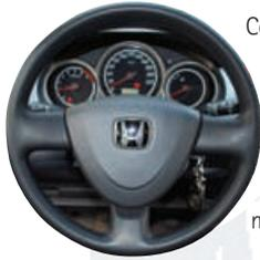
Como medida de seguridad, se emplea el volante con absorción de energía, que está estudiado sin zonas rígidas y estructura deformable.
